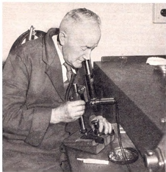
Prüfung der Lagersteine unter dem Mikroskop
